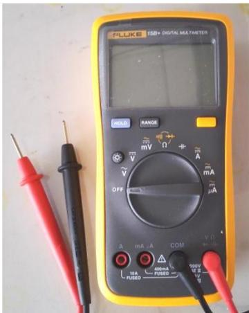
图 1.1 手持式万用表（禁止用于电流测量）
