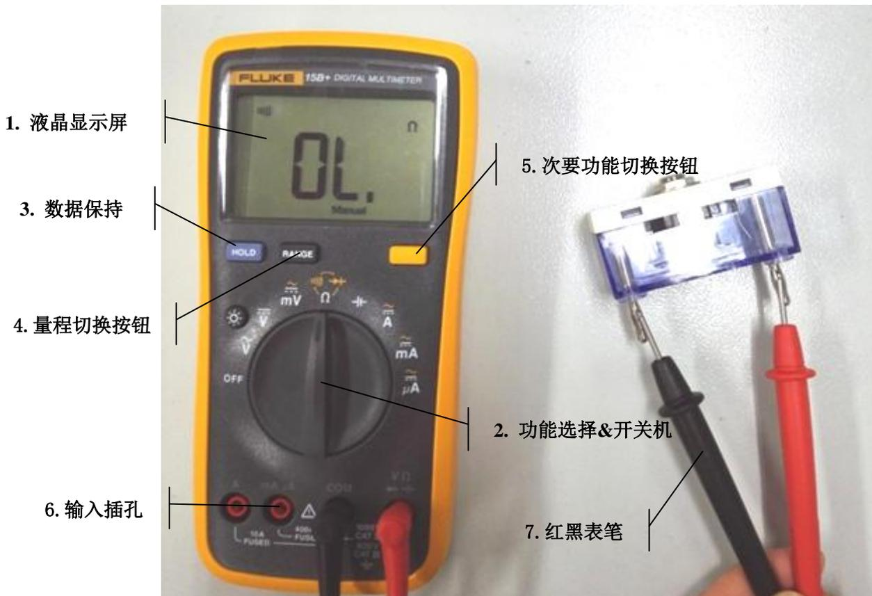
1. 液晶显示屏：显示所测量的电气参数。
